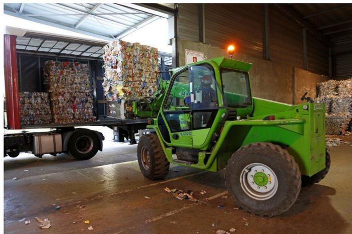
Figure 16 : Exemple d'action de chargement des balles en sortie de process
