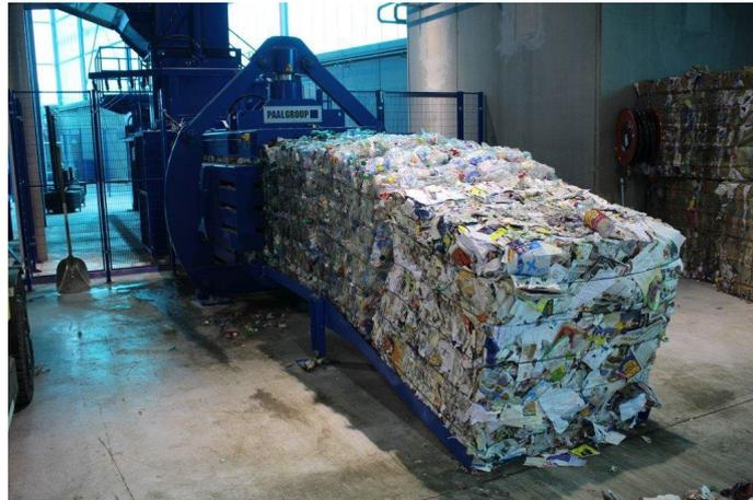
Figure 15 : exemple de canal de sortie de la presse à balle
